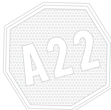
PRESEGNALE DI CANTIERE MOBILE (dimensioni in centimetri) - Fig. II 399/b Art. 39 E' una composizione alternativa del segnale Fig. II 399/a con le medesime condizioni di impiego. Misura ridotta.
