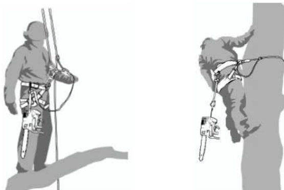
Fig. 3 – Esempi di attacchi della motosega all'imbracatura dell'operatore
