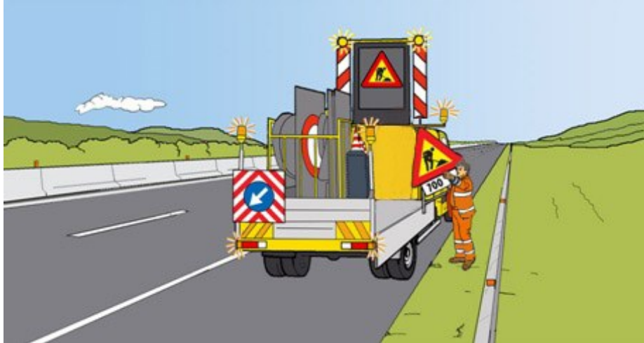
Figura 20 – Chiusura della corsia di marcia: scarico ed installazione del segnale di lavori in corso sul margine destro
